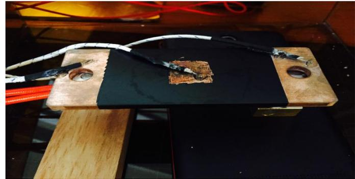
喷涂散热涂料后铜排平均降温5°C, 且两段温差由0.7增加到2.3°C
