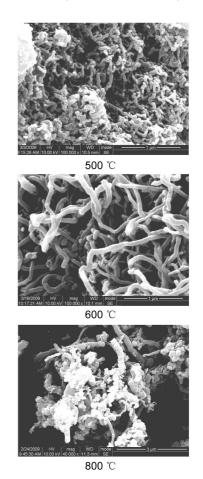
图 5 CNTs(Cat¹)的 SBM照片 Figure 5 SBM images of CNTs
