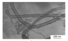
图 3 CNTs(Cat<sup>3</sup>, 600 )的 TEM照片 Figure 3 TEM image of CNTs
