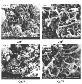
图 2 CNTs的 SEM照片 SEM images of CNTs Figure 2
