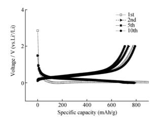
图 3 SiO/CNTs 复合电极的充放电曲线
