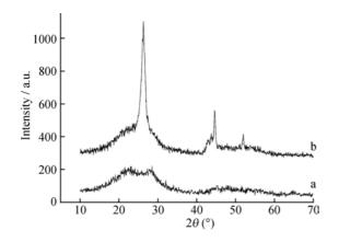
图 2 SiO 和 SiO/CNTs 材料的 XRD 图谱
