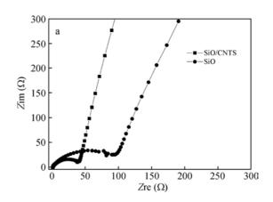
图 5 充放电前 SiO、SiO/CNTs 电极交流阻抗图谱
