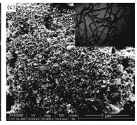
图 1 氧化硅与氧化硅/碳纳米管复合电极的扫描电镜形貌照片
